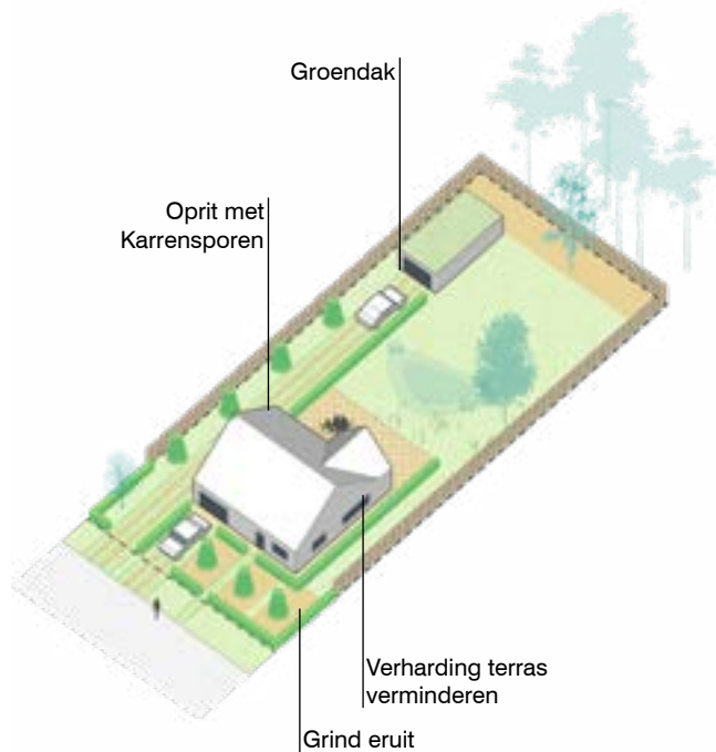
Bestaande open bebouwing
