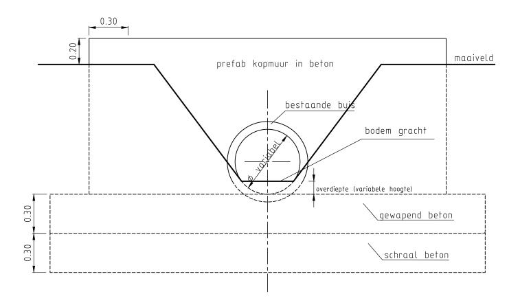
Typetekening overwelving met buizen – betonnen kopmuur – met OD
