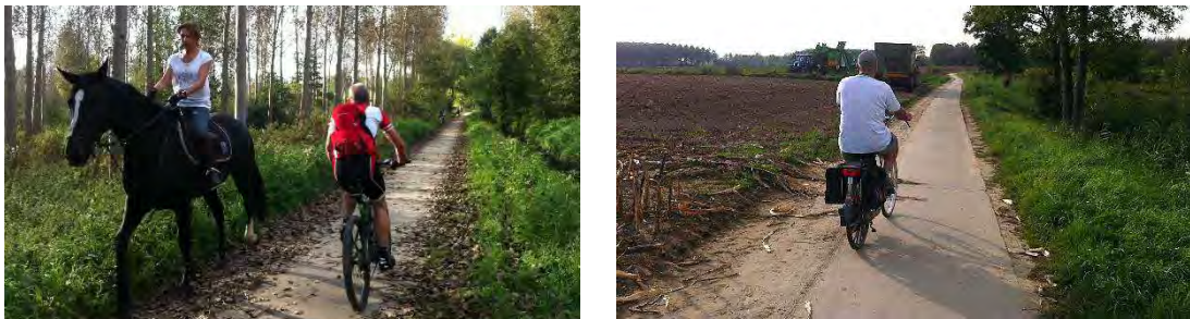
Figuur 9: Goed voorbeeld van medegebruik van een fietsroutes in de omgeving van Zoutleeuw. De onverharde strook maakt de route ook bruikbaar voor landbouwverkeer of wandelaars en paarden. De befietsbare wegbreedte is wel te smal in deze voorbeelden.
