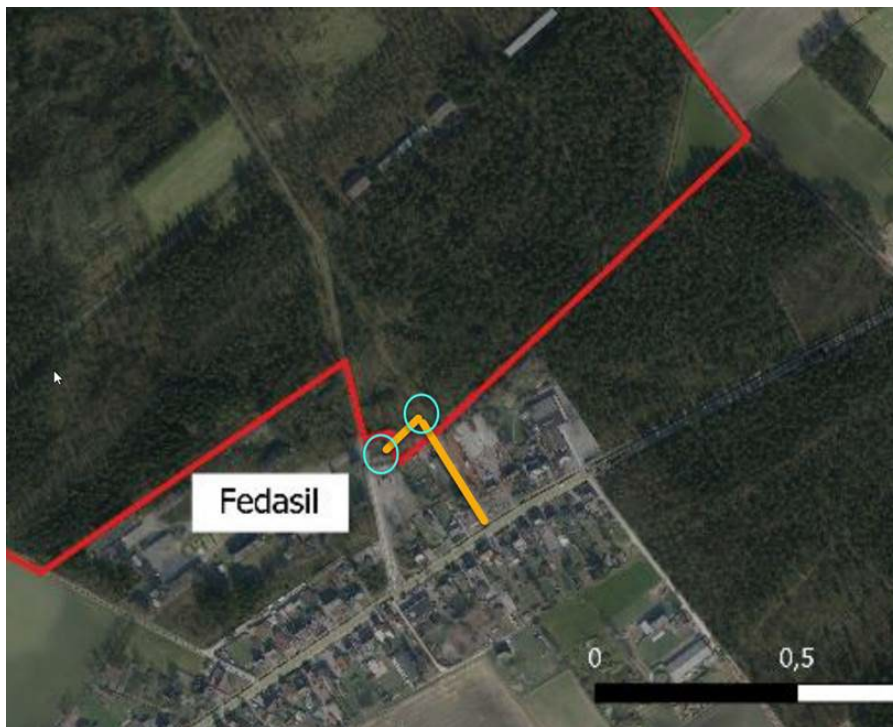
Figuur 55: Weergave van de aanwezige tracée MS, LS en OV (oranje lijn) ten opzichte van de plancontour (rode lijn). De aanwezige in dienst zijnde middenspanningscabines worden aangeduid via de blauwe cirkels
