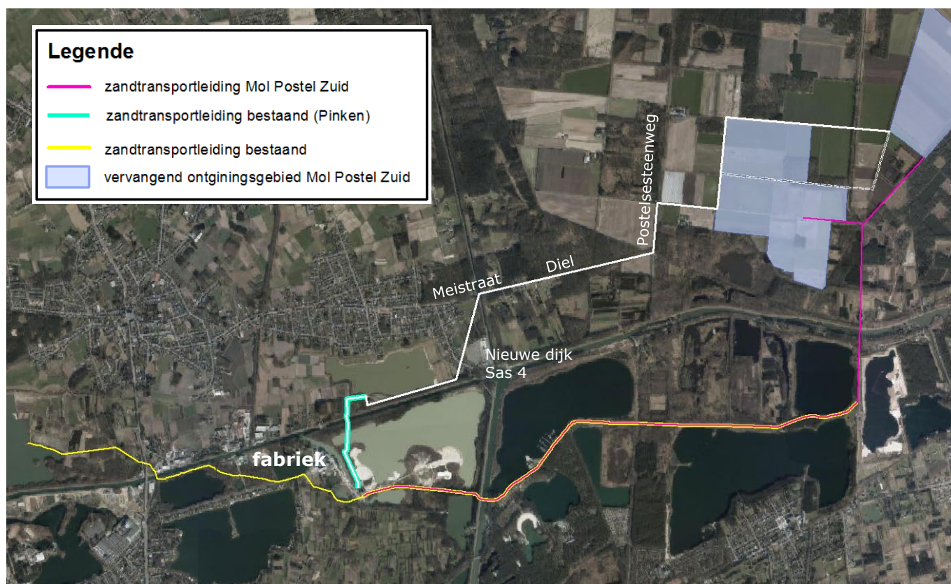
Illustratie 3.4: Alternatief tracé zandwatertransportleiding (wit), deels gebundeld met de bestaande leiding vanuit Pinken
